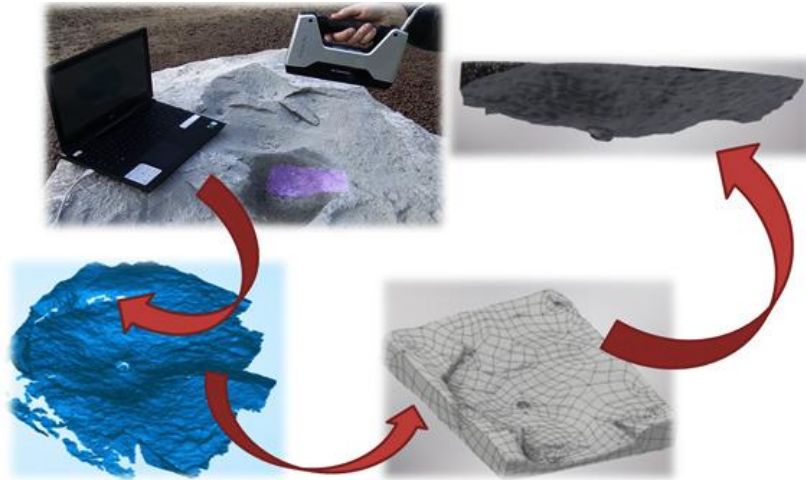
Rys. 38. Sposób wyznaczania powierzchni zniszczenia po wyrwaniu kotwy za pomocą ręcznego skanera 3D
