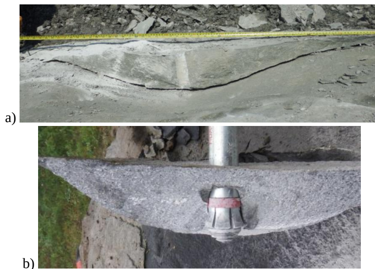
Rys. 132. Trajektorie zniszczenia piaskowców: a) BRENNa, b) BRACISZÓW
