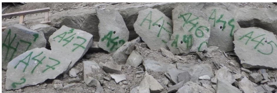
Rys. 37. Zestawienie odspojonych stożków bądź ich fragmentów dla siedmiu przykładowych prób (A41-A47) w zakresie efektywnej głębokości kotwienia h_{ef} = 47-146 mm
