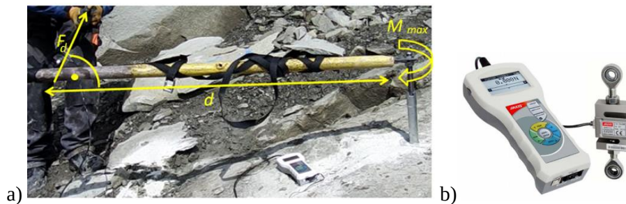
Rys. 135. Stanowisko prób zmodyfikowanej technologii odspajania: a) Sposób napędzania rdzenia kotwy podczas odrywania stożka odspojenia, F_d - siła niezbędna do obrócenia śrubą napędową kotwy, b) siłomierz elektroniczny z czujnikiem zewnętrznym (typ AX_FC1k)
