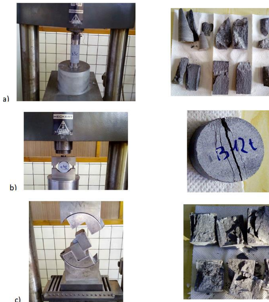
Rys. 24. Próbkki skalne w maszynach wytrzymałościowych (przed i po badaniach): a) próby jednoosiowego ściskania b) próby rozciągania metodą brazylijską, c) próby ścinania przy ściskaniu [184, 120, 157]).
